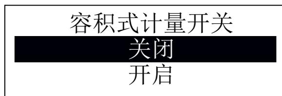
只有当容积式计量开启时，才能进入容积式计量，进入容积式计量的方法由“容积式计量启动方式”决定。
